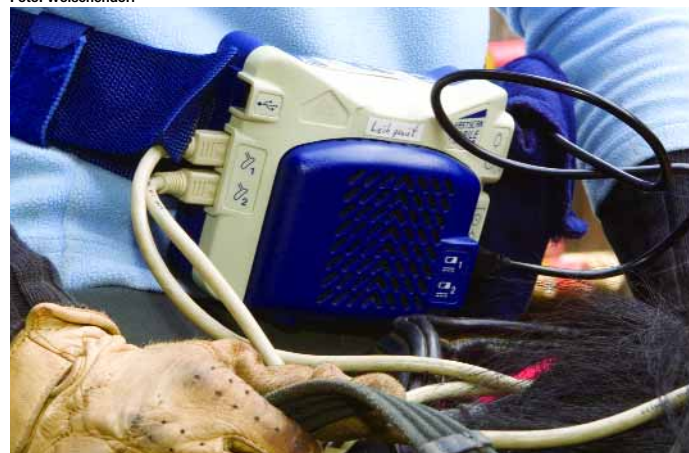
Der Datalogger am Bauch zeichnet die Messung auf.
